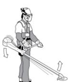
Отрегулируйте наплечный ремень таким образом, чтобы режущий инструмент располагался параллельно земле. Положите триммер, чтобы режущий инструмент слегка касался земли и отрегулируйте положение подвесного кольца до достижения правильной развесовки.
