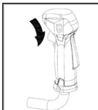
Для останова двигателя переведите выключатель зажигания в положение «О». Запустите двигатель и убедитесь, что он останавливается после перевода выключателя в положение «О».
