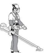
В передней части ремня размещен механизм быстрого отстегивания, который позволяет быстро сбросить триммер и ремень в случае возгорания двигателя или при возникновении аварийной ситуации.
