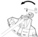
Дополнительный защитный кожух необходимо устанавливать при использовании триммерной катушки. Этот дополнительный кожух необходимо всегда снимать при использовании ножей для травы.
