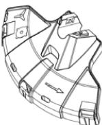
Предназначен для предотвращения выброса объектов в сторону пользователя и защиты пользователя от случайного прикосновения к режущему инструменту.
