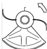
Вставьте фиксирующий штифт (A) в отверстие для фиксации вала.
