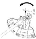
Наденьте защитный кожух на штангу и зафиксируйте его тремя болтами. Используйте рекомендованный защитный кожух (см. раздел «Технические характеристики»).
