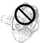
Не помещайте любые части тела в отмеченные на рисунке области. Прикосновение к указанным местам может привести к ожогам или поражению электрическим током (если поврежден свечной наконечник). Всегда используйте перчатки. Не эксплуатируйте триммер с поврежденным свечным наконечником.
